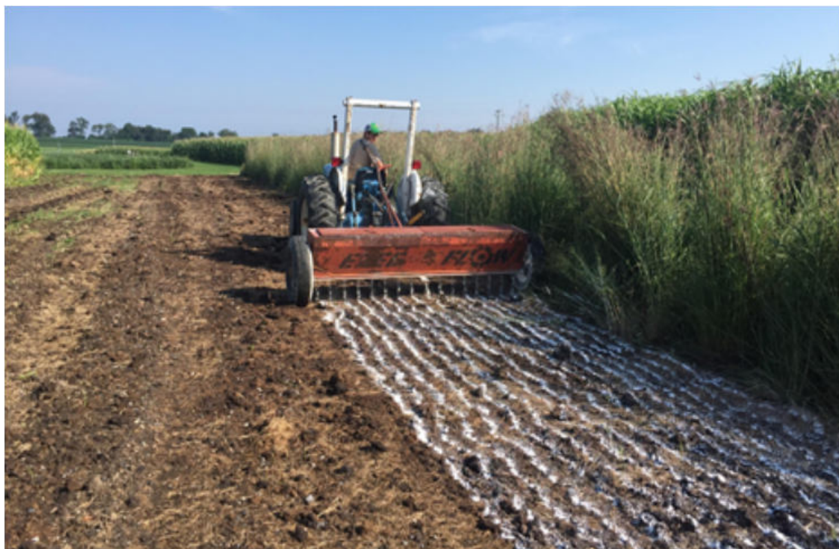
Imagem 01: Meramente ilustrativa, Distribuidor de calcário (TIPO COCHO) - Fonte Embrapa Trigo - Giovani Faé
