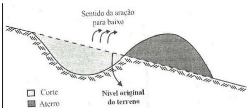
Figura 9 – Demonstrativo quanto ao processo de construção (Fonte: Prusky, 2009).
