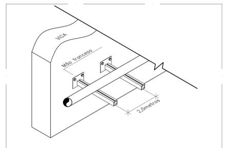
DETALHE DA TUBULAÇÃO FIXADA NA VIGA
