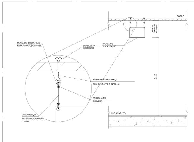
DETALHE DE INSTALAÇÃO DE PLACAS DE SINALIZAÇÃO NO FORRO ATRAVÉS DE SUPORTE NO TETO
