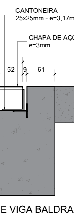
DETALHE DO DESVIO DA CANALETA NO CASO DA EXISTÊNCIA DE VIGA BALDRAME ESC. 1/50
