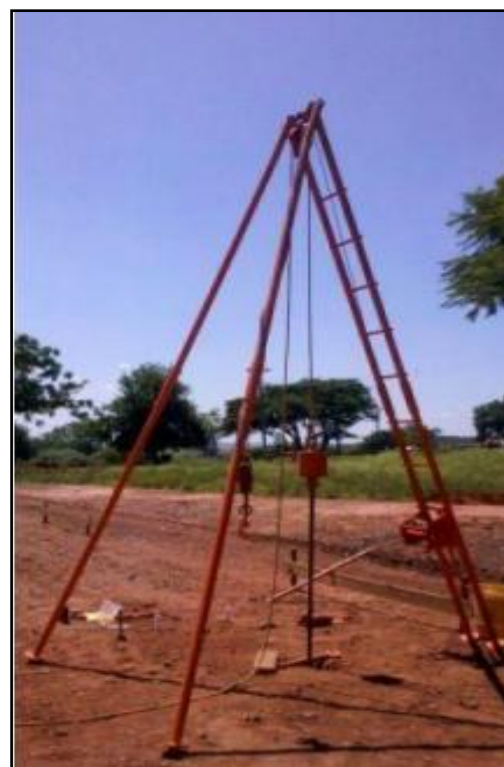
Figura 2 – Equipamento de sondagem - SPT
