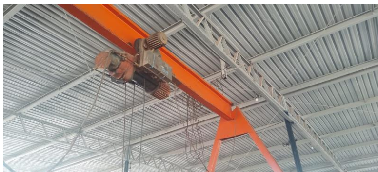
Imagem 14 – Motor do pórtico com guincho elétrico – vista detalhada do conjunto motriz. (Equip. 03)
